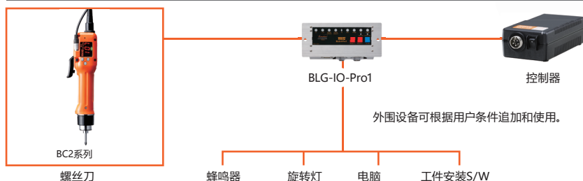
BLG-IO-Pro1 【连接外围设备示意图】
