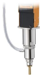
ドライバー先端に装着し、ポンプと接続することでネジをビット先端に吸着することができます。真空吸着方式を採用し、マグネットのようにネジの材質を気にする必要がなくなります。
