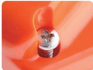
深穴の締め付け・ネジ浮き
