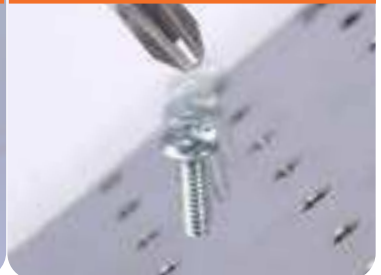
螺丝倒落 / 横拧 / 斜拧
